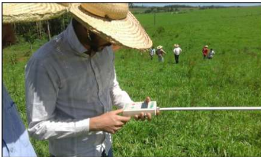
Figura 16. Leitura da de interceptação luminosa e índice de área foliar com o aparelho AccuPAR Linear PAR/LAI ceptometer do capim-Convert HD364.
